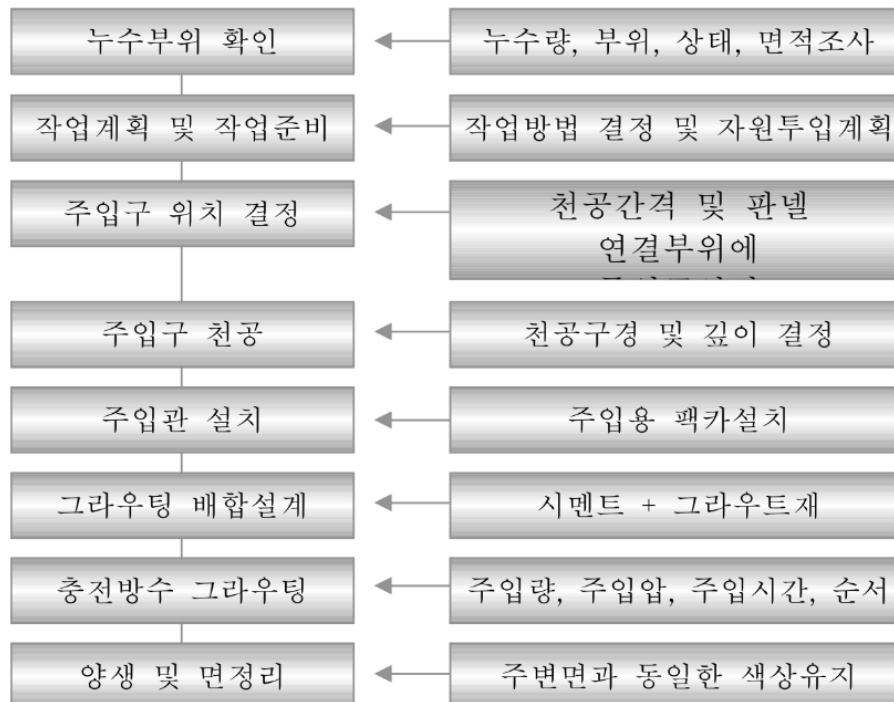
【그림 6.3.10】 충전주입방수 공법의 시공순서도
